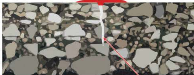
Fisură în suprafața asfaltică
